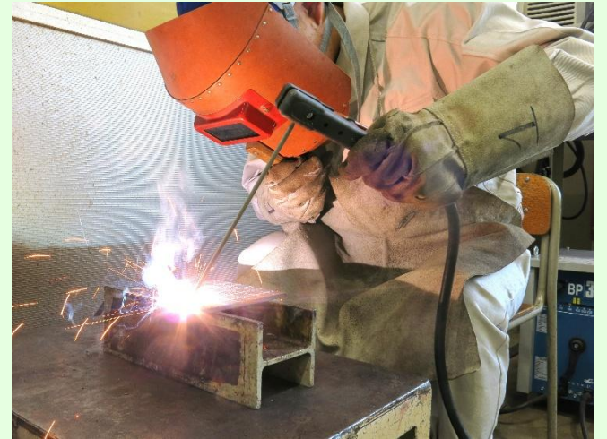
溶接実習（被覆アーク溶接）
