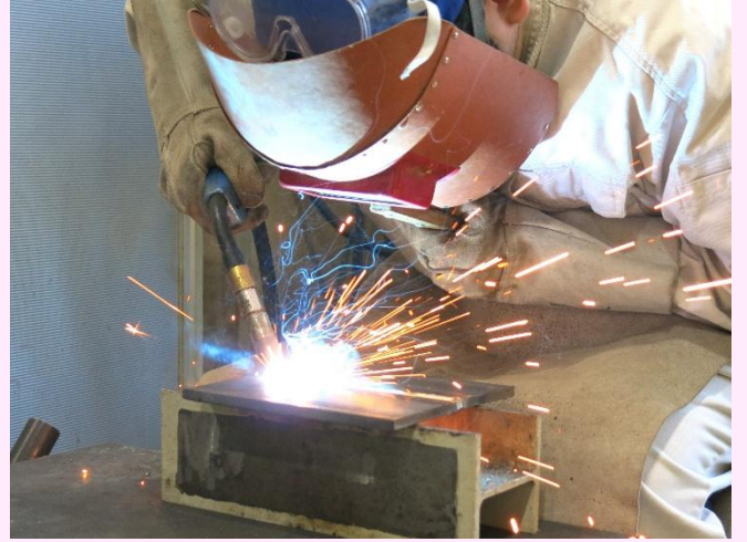
半自動溶接実習
