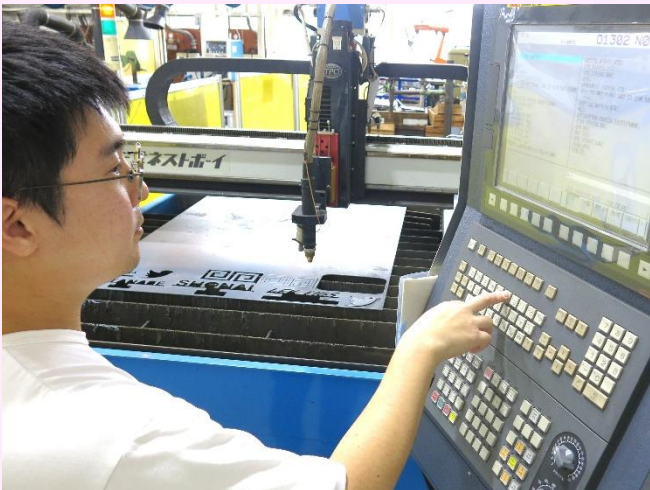
プラズマ切断機操作実習
