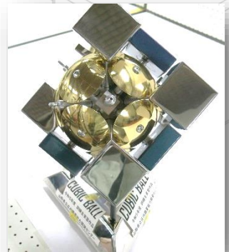
キューブ組立 材質：SUS304,t1.5mm (TIG溶接・仕上げ・塗装)
