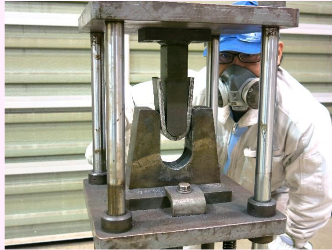
検査実習 (曲げ試験)
