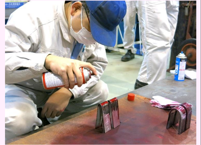
検査実習 (浸透探傷試験)
