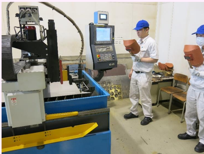
プラズマ切断加工
