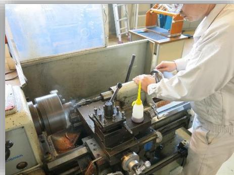
③旋盤による機械加工実習
