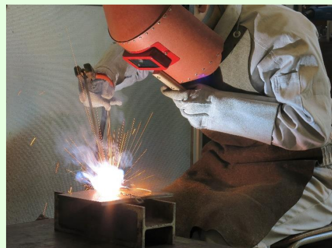
溶接実習（被覆アーク溶接）
