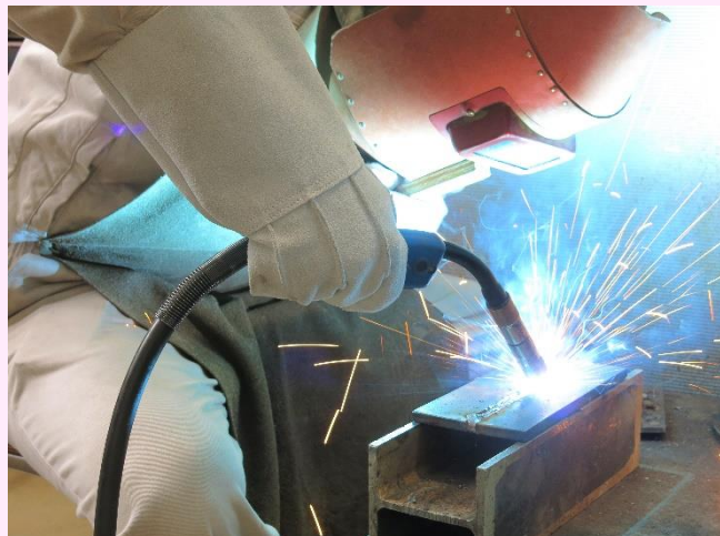
半自動溶接実習
