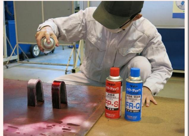
浸透探傷試験 (検査実習)
