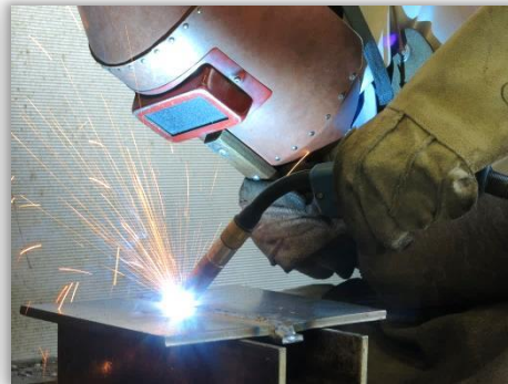
②半自動溶接機による溶接実習
