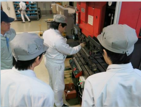
①プレスブレーキによる板金実習
