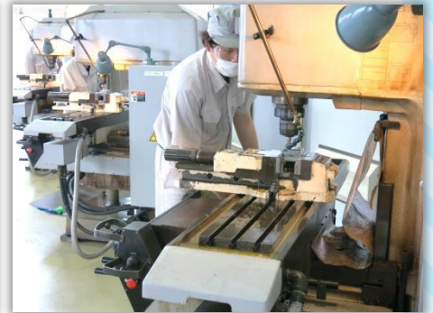
③フライス盤による機械加工実習
